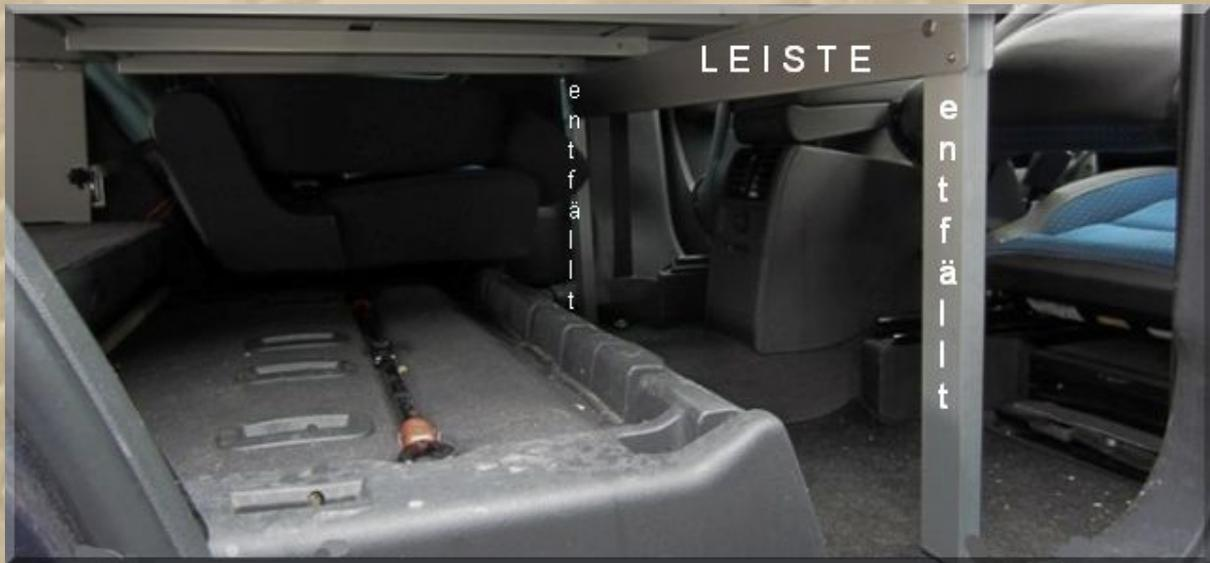
gleiche ich durch eine Leiste mit Schraubösen aus, die ich mit einer Dyneema Whoopie Sling, in erforderlicher Höhe, in die Gurtaufhängungen in den Türholmen ein- und aufhänge und unter das erste Brett direkt hinter den Frontsitzen unterlege. Somit erübrigt sich ein aufwendiger Unterbau zum Niveaueausgleich, und der Stauraum der entfernten Fondsitze unter dem Bett bleibt voll nutzbar.
