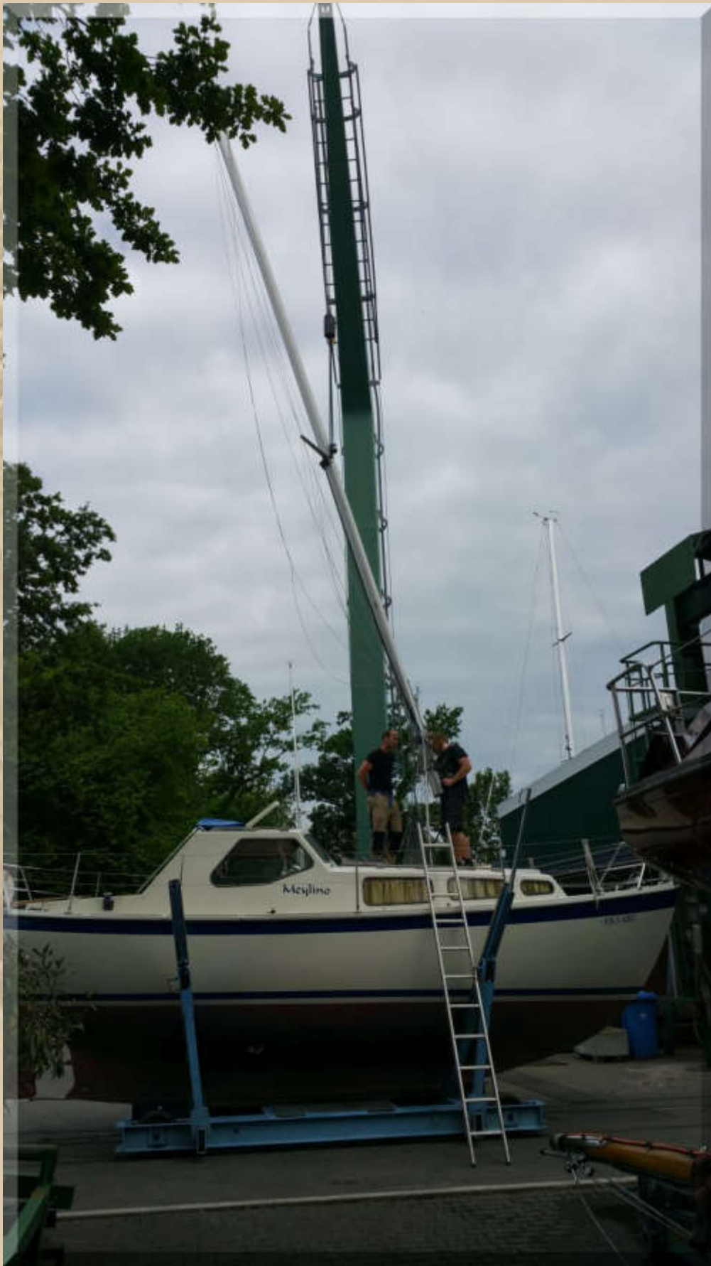
.... der Mast wird gestellt
