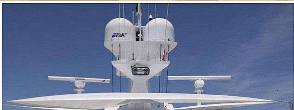
EPAC selbstausrichtende Satellitenantennen für Schifffahrt, Wohnmobile etc.
