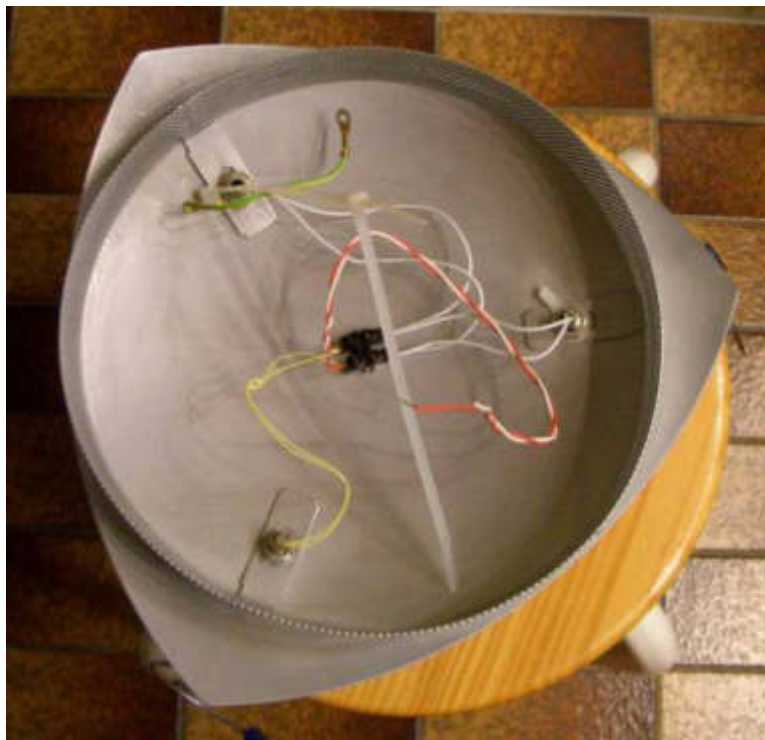
Lampenträger: Gelb (Teflon) = neu
