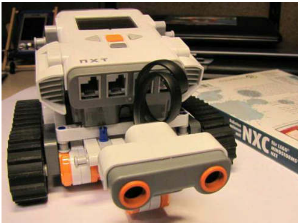
Der Ultraschallsensor zur Entfernungsbestimmung
