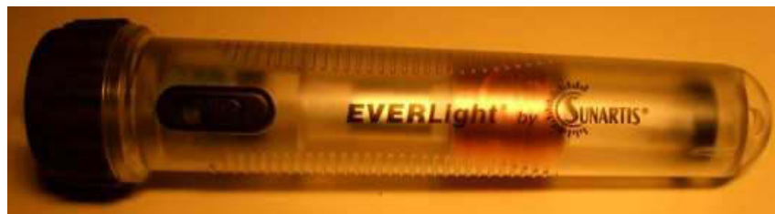
m@n erkennt die Spule und links d@neben den beweglichen M@gneten
