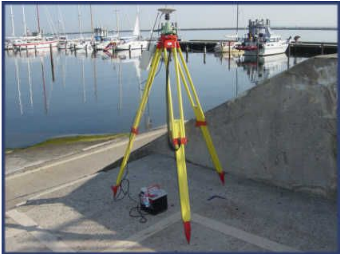
alte Messpunkte werden jetzt mit GPS neu eingemessen
