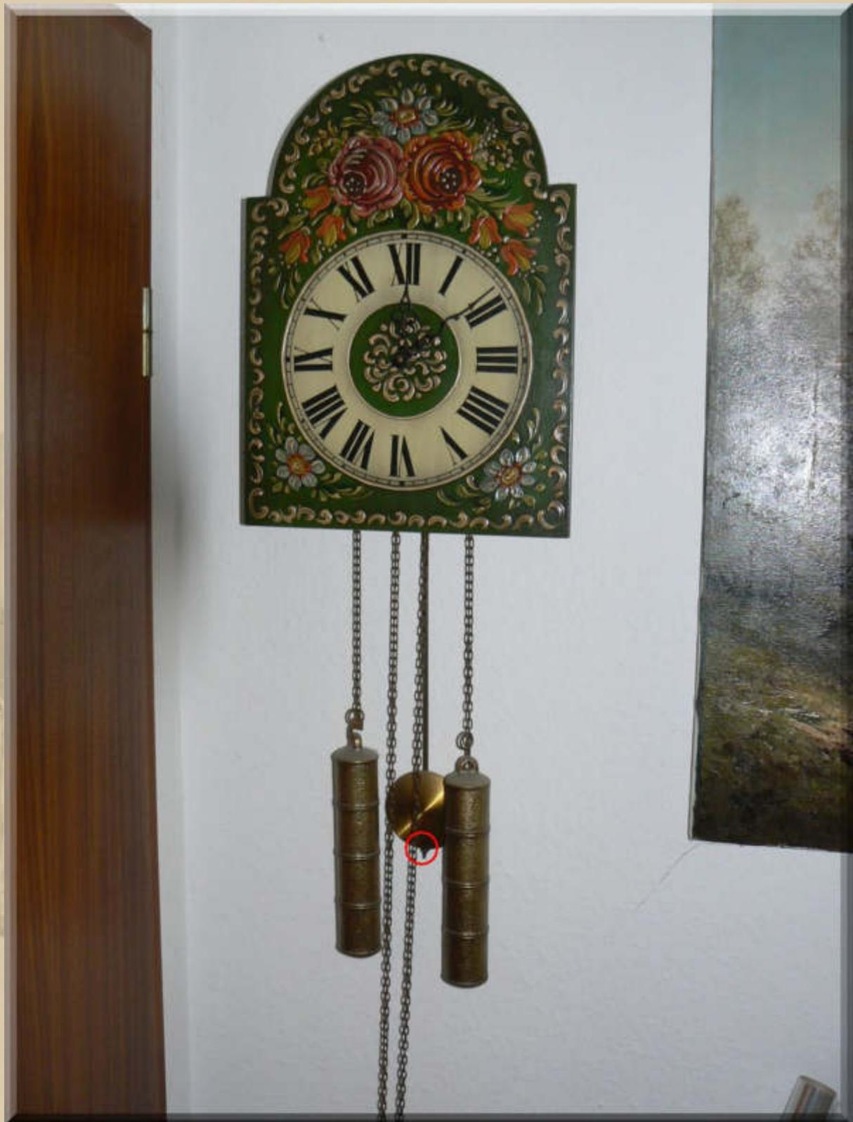
.... mit der Stellschraube am Pendel kann man die Uhren auf eine Ganggenauigkeit von +/- 3 Sekunden pro Woche justieren.
