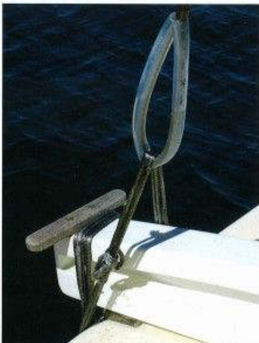
Laschings statt Schrauben. Das gesamte Boot ist mit extrem reißfestem Dywida-Tauwerk verbunden. Auch die Wanten sind festgelaht.
