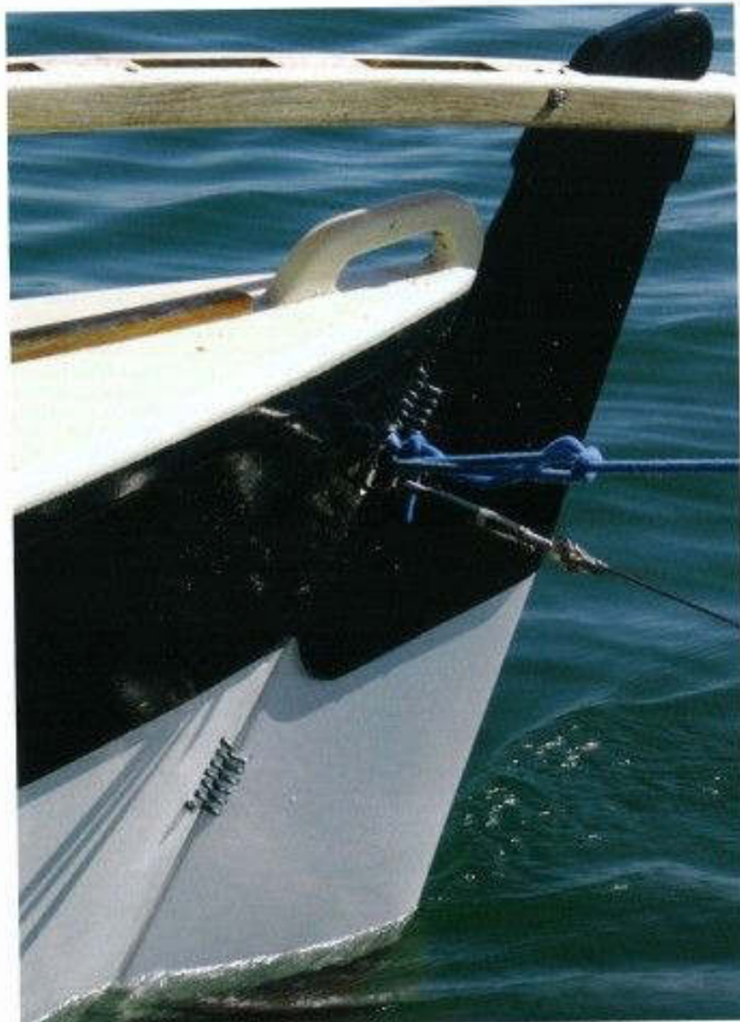
Typisch Wharran und genial noch dazu: Sogar die Ruderbeschläge bestehen aus Tauwerk. Das ist leicht, spießig, preisgünstig und einfach zu reparieren. Die Wandung der Bohrungen muss innen sorgfältig mit Epoxid abgedichtet sein, sonst entsteht eine Quelle für Feuchtigkeit und Fäulnis.
