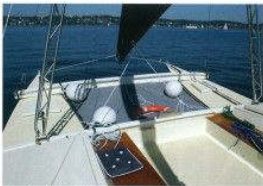
Freier Durchgang aufs Vorschiff. Der fehlende Mast in der Mitte ist ein Vorteil des Riggkonzepts.
