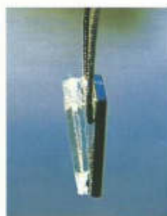
Seitenansicht: drei Scheiben mit Distanzstücken oben und direkter Verklebung unten.
