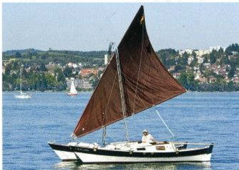
Andreas Weber genießt das entspannte Segeln auf seinem Katamaran. Er muss mit seinem Boot weder repräsentieren noch in einer bestimmten Zeit von „A“ nach „B“ gelangen. Der Gittermast steht auf einem Gelenk und kann im Bedarfsfall einfach umgelegt werden.
