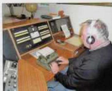
Bild 2: Hans-Jörg Pust, DL7DAN, am Telegrafie-Funkarbeitsplatz bei der Telegrammaufnahme; links der Empfänger Telefunken E 1506, in der Bildmitte das Bedienfeld für alle A1-Sender und Tastleitungen in den KW-Seefunkbändern
