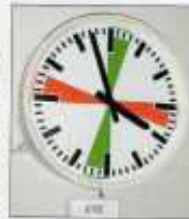
Bild 8: Seefunkuhr mit den Zeitfenstern für die Seenotpau- sen 500 kHz (rot) und 2182 kHz (grün)
