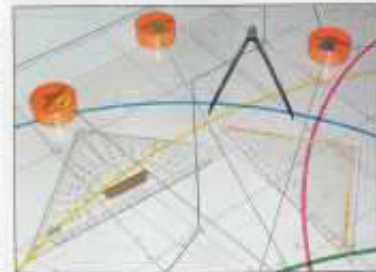
Bild 4: Peilfunknetz Nordsee, Peiltisch mit Seekarte Deutsche Bucht, Positionsermittlung mittels Kreuzpeilung und nautischem Handwerkszeug
