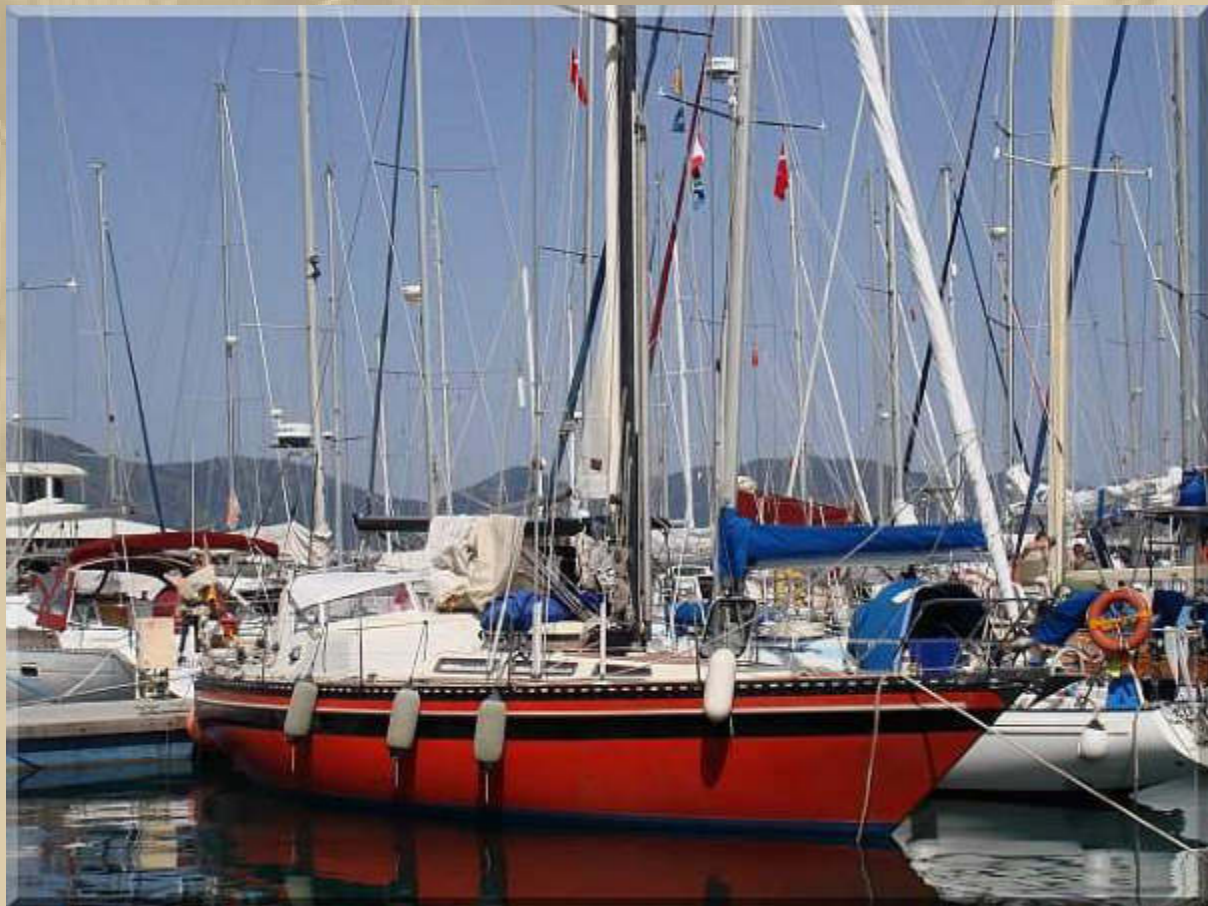
SY Ypsilon, ein Cruiser-Racer vom Typ Emka 36' - dtsh. Werftbau ( BJ 1983 10,80 x 3,40 x 1,80 m ~7,5 to. )
