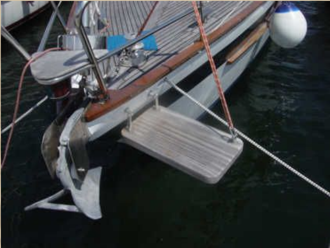
..... eine fest installierte Klappstufe aus massivem Teak
