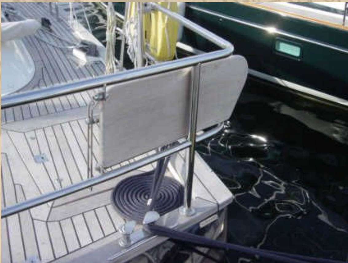
Detaillösung eines klappbaren Heckkorbsitzes der Sonderklasse auf einer Contest 44 CS - noblesse oblige
